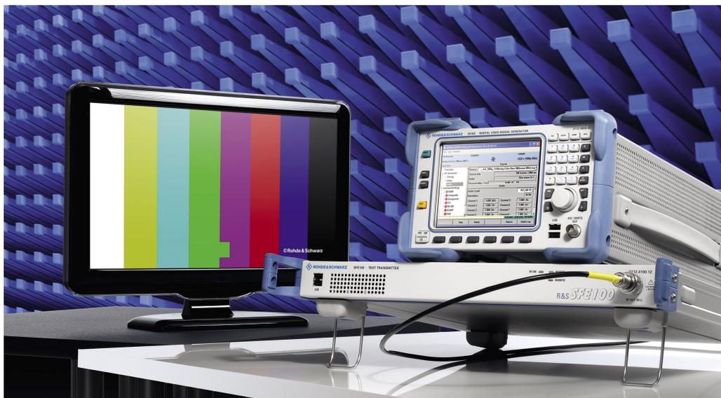
Fig. 1 Essais CEM sur téléviseurs avec le générateur de signaux vidéo numériques R&S®DVSG et l'émetteur de test R&S®SFE100.
